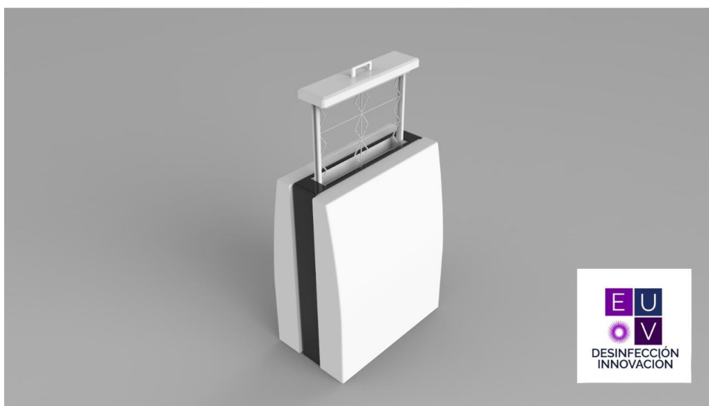
Figura N°4. Diseño propuesto por el grupo de estudiantes ganador del premio Santander X para la desinfección de mascarillas N95. En la figura se observa una manilla que permite desplazar una repisa de abajo hacia arriba que en su interior contiene finos alambres para colgar allí las mascarillas N°95; al interior se emite la radiación UV con una distancia mínima entre las mascarillas y la fuente emisora de luz, sin exponer al personal de salud a los rayos UV que se emiten desde la máquina.
