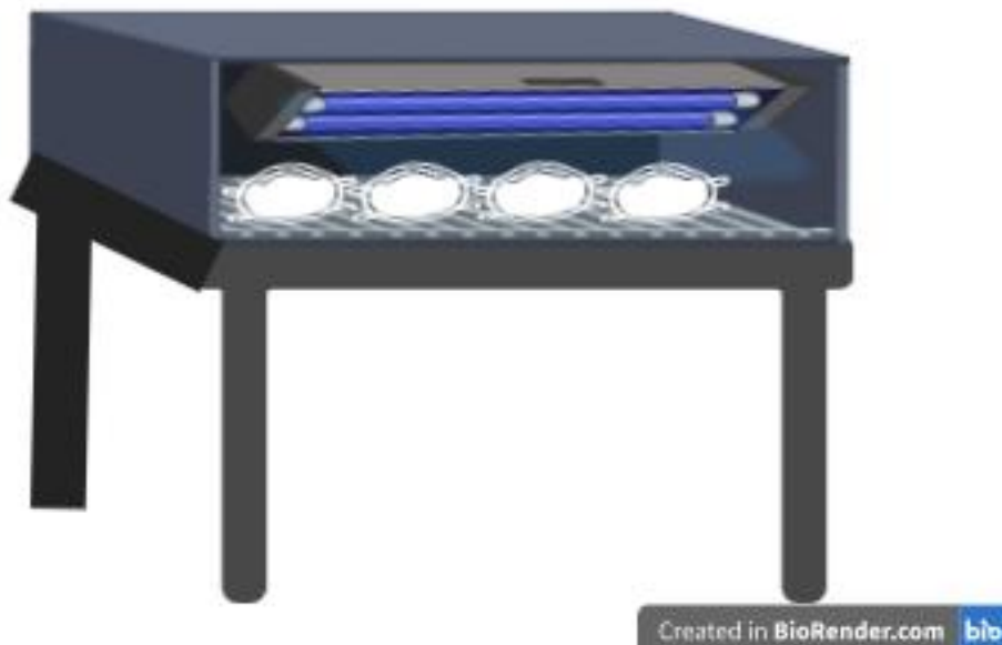
Figura N°2. Esquematización de prototipo de diseño de desinfección de mascarillas N°95 mediante una mesa y una caja adaptadas para disminuir la distancia entre la fuente emisora de luz UV y la superficie de las mascarillas, este diseño implica que se necesita rotar manualmente las mismas después de un determinado tiempo para permitir que ambas caras o superficies reciban la luz y se desinfecten. Adaptación gráfica desde modelo presentado por Hamzavi et al, 2020.
