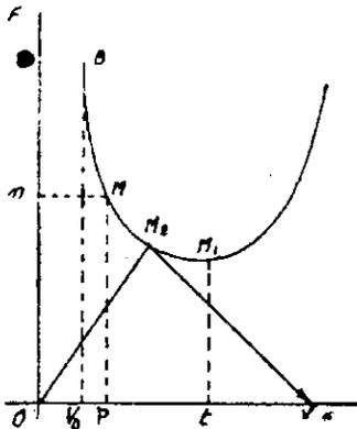
Se puede determinar la mínima potencia con que se puede volar en un aeroplano.
